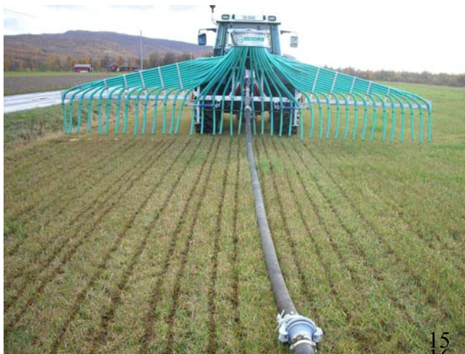
4 5 Bilde 2 Stripespreder montert på tankvogn 6
