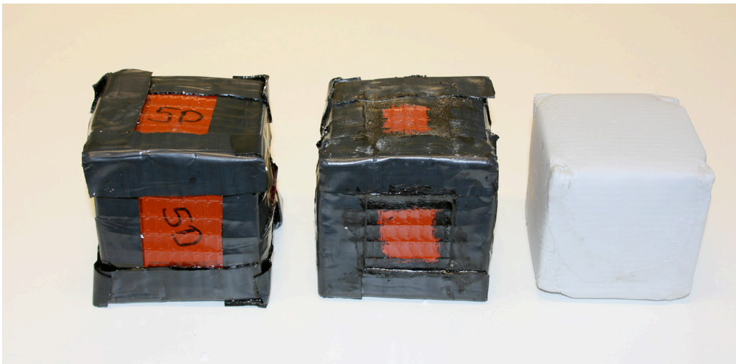
Figur 1. Tre typer testklosser dekket med radonmembran. Fra venstre mot høyre: RMB 400 tett med skjøtebånd, RMB 400 med skjøtebånd og fugemasse, og Protan Radonsafe som er varmluftsveiset i skjøtene.
