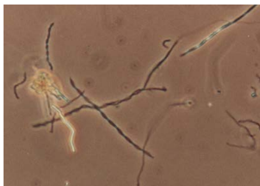
Figur 6: Gallionella -tråder etter avfarging med oksalsyreagens. Foto: Unni Steinsmo, SINTEF.
