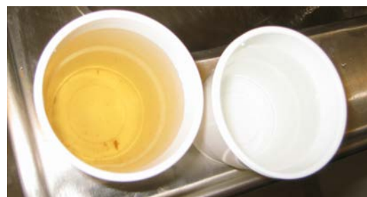
Figur 4.22: Farge på vann før og etter humusfjerning (Foto: Jens Erik Pettersen)
