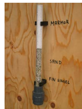
Figur 4.24: Filterinnhold i marmorfilter (Foto: Bjørn Løfsgaard)
