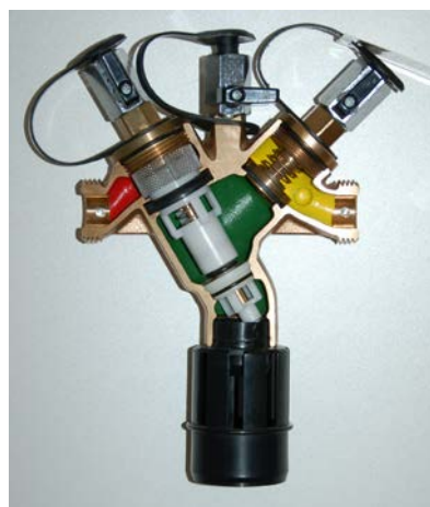
Figur 5.13: Andre væskesystemer bør ikke forsynes med drikkevann. Dersom dette ikke er til å unngå, gir brutt forbindelse eller en ventil av type "BA" best beskyttelse. Legg merke til de tre testportene på ventilens topp. En slik ventil må utstyres både med forfilter og stoppventiler som muliggjør testing (Foto: Eyvind Andersen)
