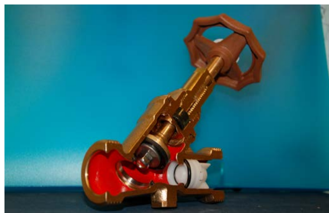
Figur 5.14: Kontrollerbar tilbakeslagsventil med integrert stoppventil. Testporten er på undersiden mellom den hvite tilbakeslagsventilen og stoppventilen (Foto: Eyvind Andersen)
