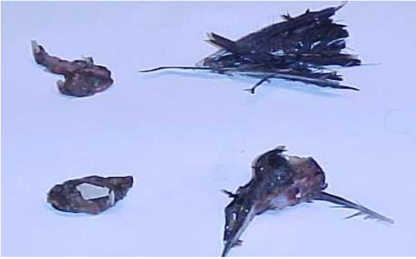
Figur 5.6: Rester av en fugl funnet i drikkevannstanker. Den kom inn via bunkringslangen, ble sittende fast i en ventil, og ble spredt til alle tankene når den gikk i oppløsning (Foto: Bildet brukes anonymt etter avtale med selskapet)
