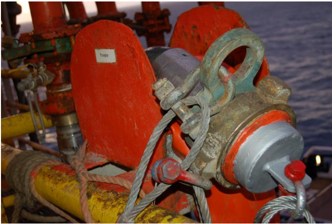
Figur 7.4: Bunkringsslange med godt festet endeplugg (Foto: Eyvind Andersen)
