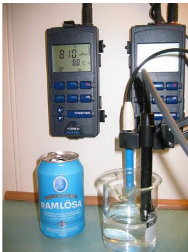
Figur 4.9: Noen typer naturlig mineralvann har høyt saltinnhold, noe konduktivitetsmålingen her viser (Foto: Eyvind Andersen)
