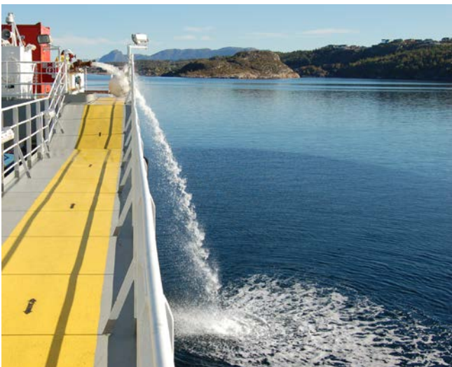
Figur 7.8: Tømming av tank. Drikkevannstanker bør tømmes så mye som mulig før de på nytt fylles. Dette gjelder for både forsyningskip og offshore-innretninger (Foto: Eyvind Andersen)
