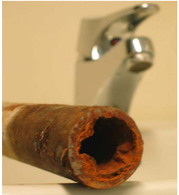
Figur 4.4: Rustknoller kan gi dårlig vann og føre til gjentetting av rør (Foto: Eyvind Andersen)
