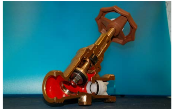
Figur 9.18: Kontrollerbar tilbakeslagsventil med integrert stoppventil. Testporten er mellom tilbakeslags- og stoppventilen (Foto: Eyvind Andersen)
