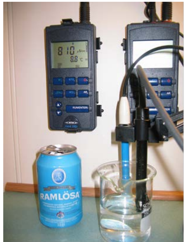
Figur 4.9: Noen typer naturlig mineralvann har høyt saltinnhold, noe konduktivitetsmålingen her viser (Foto: Eyvind Andersen)
