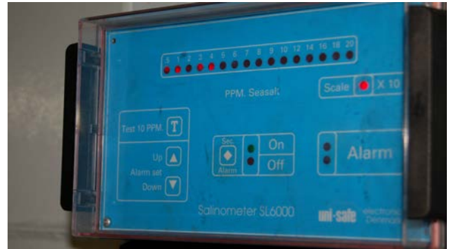
Figur 6.8: En konduktivitetsmåler sørger for at produsert vann automatisk sjekkes, og dumpes dersom grenseverdien overskrides (Foto: Eyvind Andersen)
