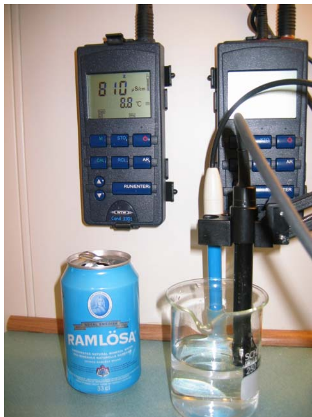
Figur 4.8: Noen typer naturlig mineralvann har høyt saltinnhold, noe konduktivitetsmålingen her viser (Foto: Eyvind Andersen)
