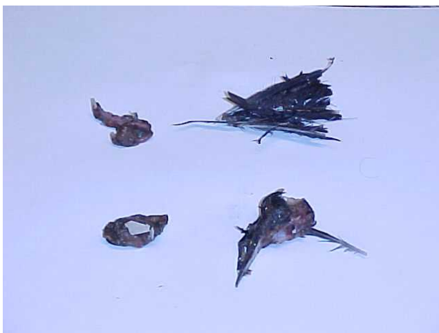
Figur 9.1: Rester av en fugl funnet i drikkevannstanker. Den kom inn via bunkringslangen, ble sittende fast i en ventil, og ble spredt til alle tankene etter hvert som den gikk i oppløsning (Foto: Bildet brukes anonymt etter avtale med selskapet)
