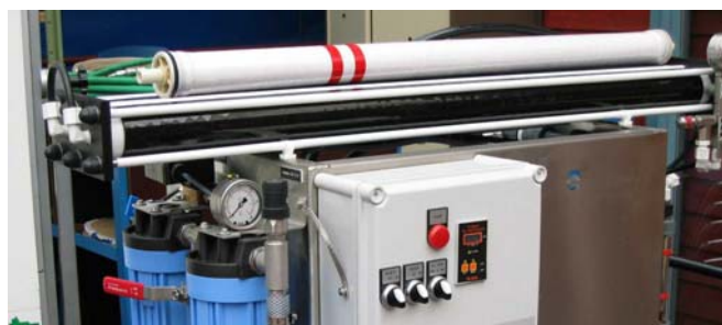
Figur 6.6: Omvendt osmoseanlegg. Membranen er en rull inne i røret øverst (Foto: Bjørn Løfsgaard)
