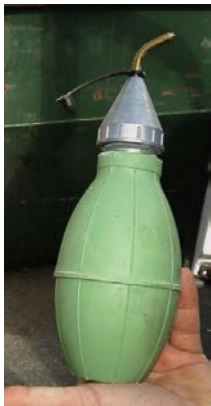
Pulverapparater er små og hendige, men pulver kommer lett på avveie og gir uønsket gifteksposering.
